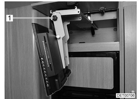
Bild 32 Flachbildschirm in Fernsehstellung
