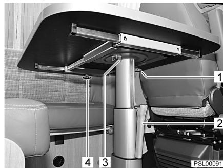
Bild 30 Hubtisch verschieben/schwenken
